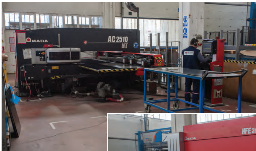
Процесс штамповки материала
