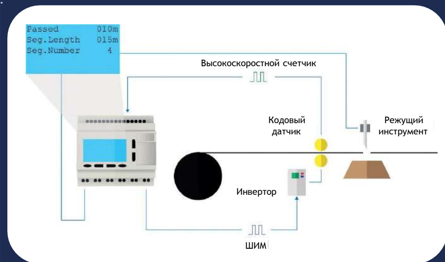
▲ Пример приложения: управление высокоскоростным счетчиком, позиционированием и функциями-ввода-вывода с помощью одного и того же устройства.
