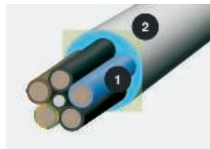
Диаметр кабеля (1) и необходимое пространство (2)
