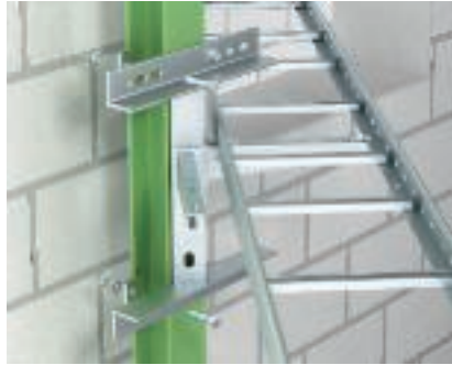
Адаптерная пластина 45°, для монтажа на стальной конструкции Монтаж адаптерной пластины 45° KA-E 45 на стальной балке с помощью фиксирующих углов и зажимов. Для дополнительной поддержки кабельных трасс в углах помещений.
