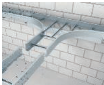
Монтаж T-образной секции T-образная секция в комбинации с кабельным лотком лестничного типа для больших расстояний. T-образная секция крепится к кабельному лотку лестничного типа с помощью внешних соединителей.
