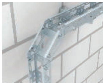
Вертикальная угловая секция 90° нисходящая Монтаж нисходящего вертикального угла с помощью шарнирных соединителей SV.
