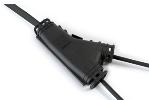
3. Накинуть крышку и защелкнуть соединительную коробку. Проверить выход геля по краям соединения.
