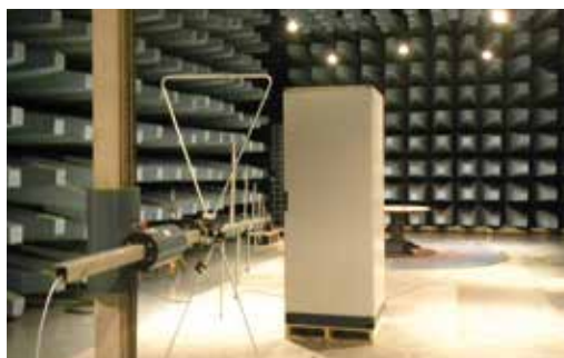
Распределительные коробки серии SD (сравнение ЭМС и стандартной версии)
