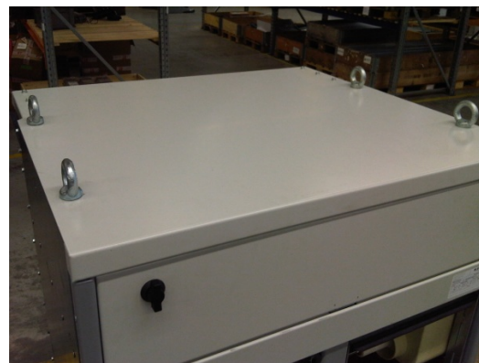
Рис. 3-2. Подъёмные кольца на измерительной панели
