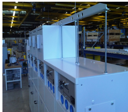
Рис. 3-3. Подъёмные приспособления на соединённых КРУ
