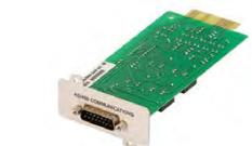
Релейная плата BD (для ИБП Eaton 9130)
