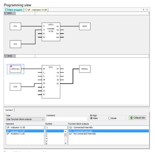
Figure 228: Inputs/outputs wiring
