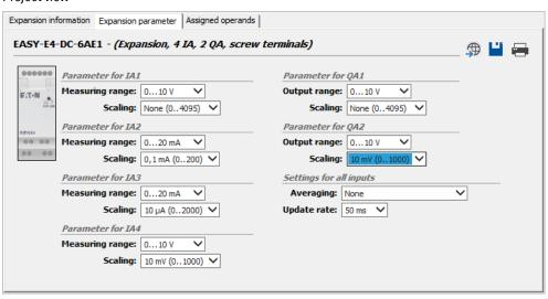
Figure 23: Device parameters tab
