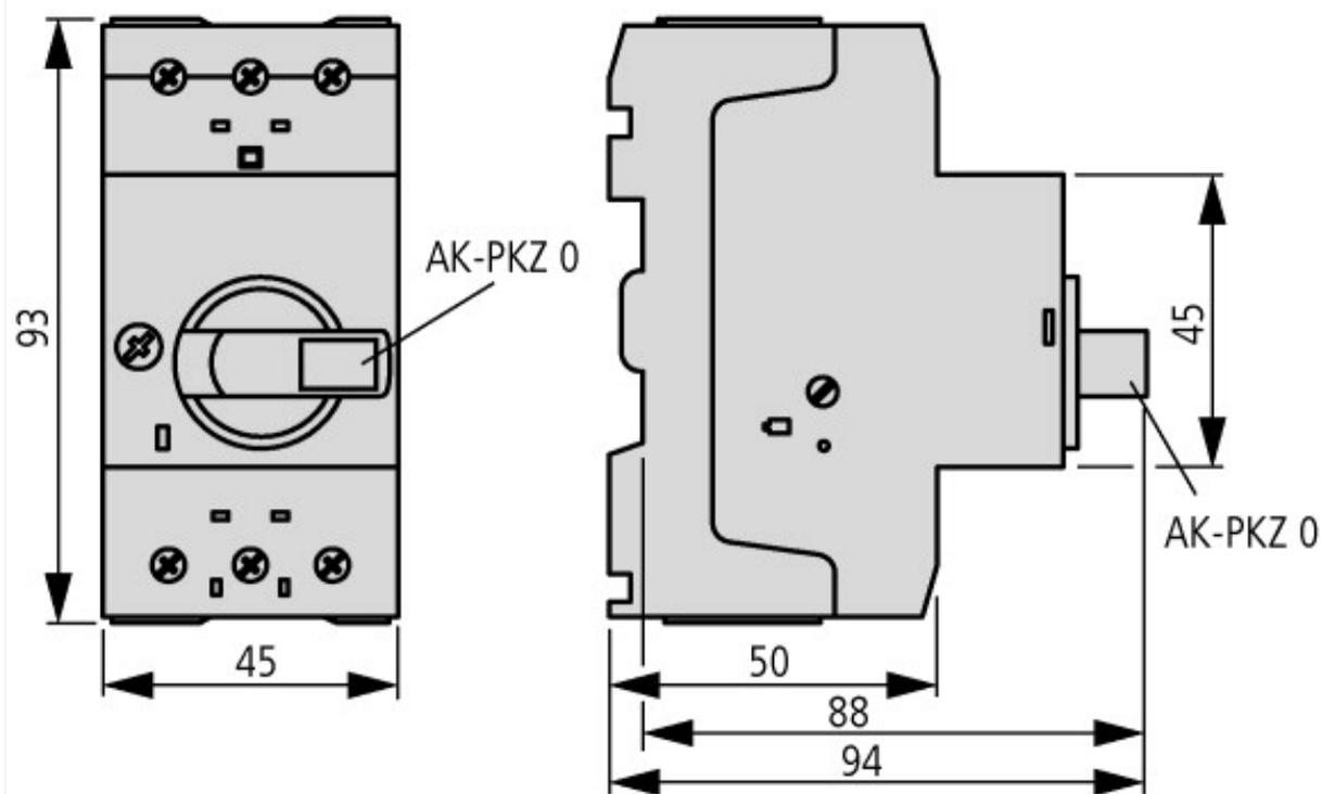
Автомат защиты двигателя с запираемой поворотной ручкой
