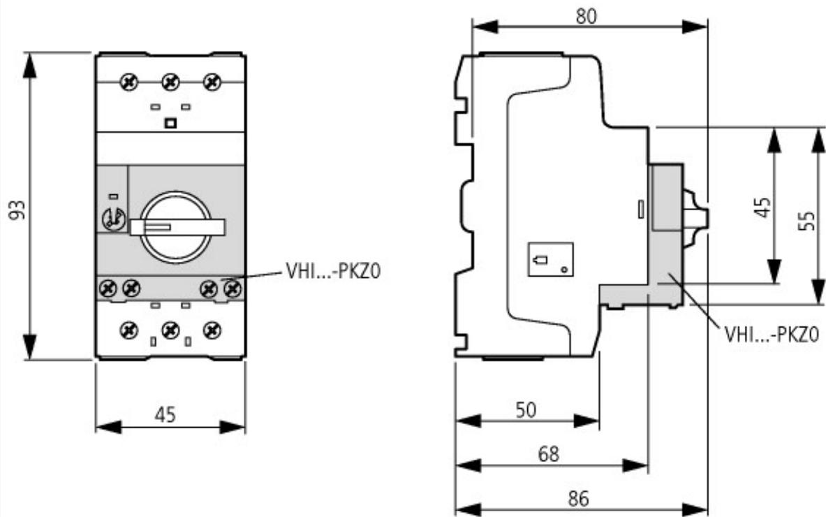
Автомат защиты двигателей с опережающим вспомогательным контактом
