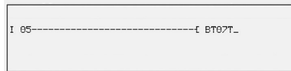
Рис. 180: Соединения триггерной катушки
