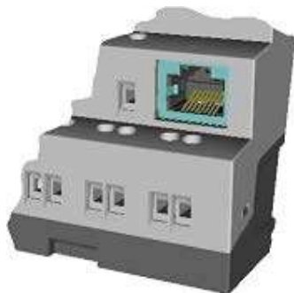
Рис. 32: Гнездо RJ-45, 8 контактов
