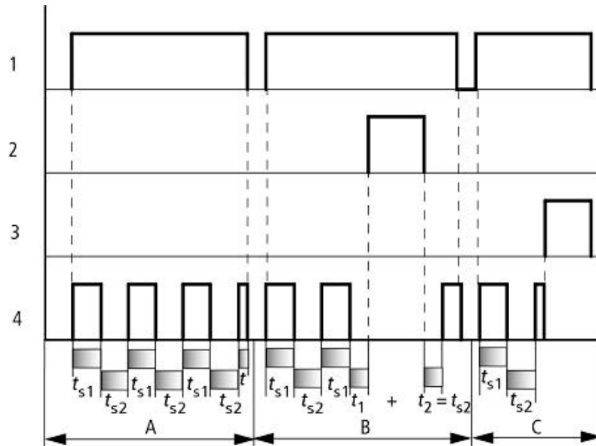
Рис. 125: Диаграмма сигналов реле времени, единственный импульс 1
